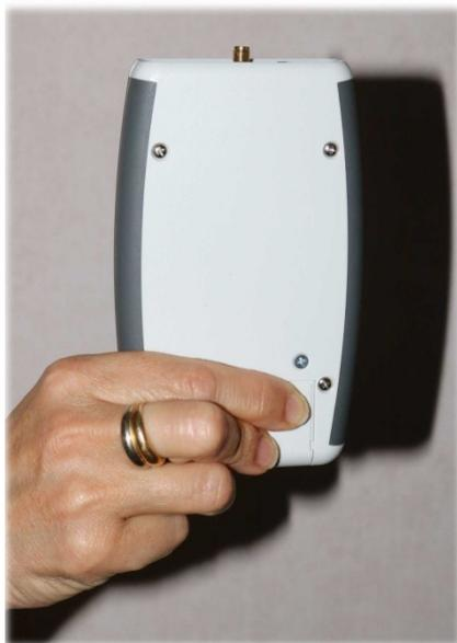
L'appareil doit être « mis à la terre » en plaçant un doigt au point de mise à la terre, sur la face arrière de l'appareil. Il s'agit d'une vis située au-dessus du boîtier des piles.
