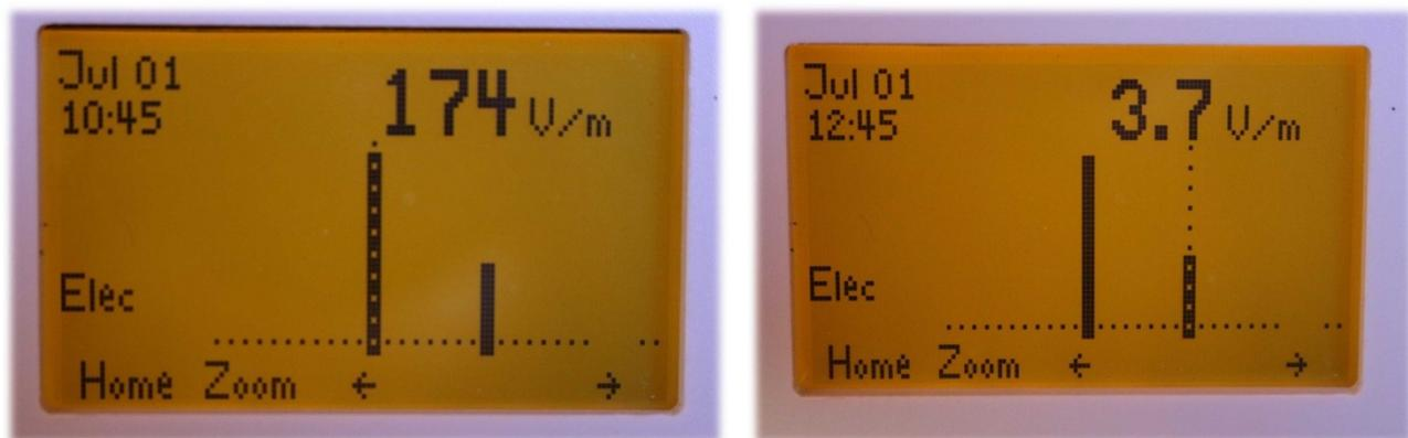
Avec les touches **3 et 5**, vous déplacez le curseur. Dans l'exemple, le 1<sup>er</sup> Juillet 2020, en mode Elec, le niveau mesuré était de 174 V/m à 10h45 et de 3,7 V/m à 12h45.
